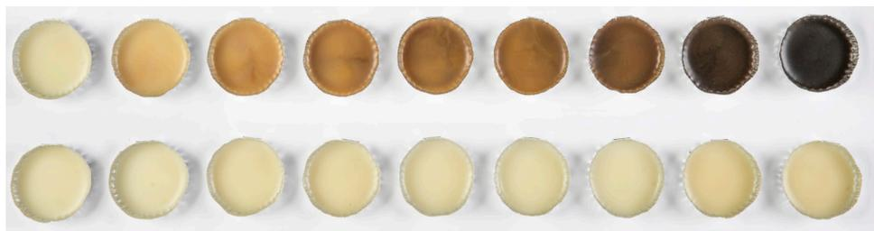
*Für diese Stichproben wurde jeder Schlauch mit demselben Klebstoff gefüllt, dann verschlossen und bei gleichmäßiger Temperatur gehalten. Zu den angezeigten Zeiten wurden die Schläuche geöffnet, eine Klebstoffstichprobe wurde entfernt (abgebildet), und der Schlauch wurde wieder verschlossen.*
