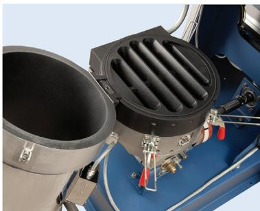
Kippbarer Tank für einfache Reinigung und Wartung
