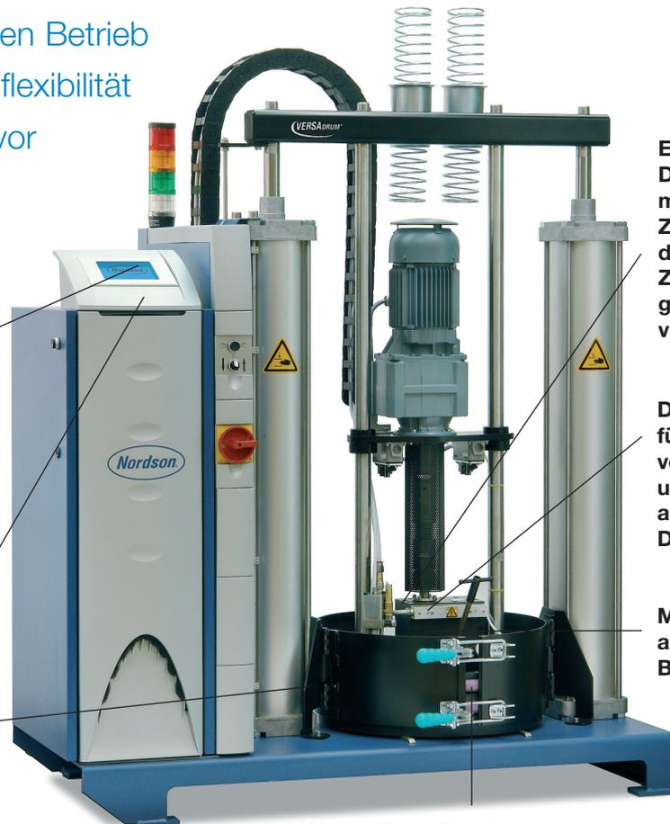
**Exakt regelbare Drehstrommotoren mit dosierenden Zahnradpumpen, die optional als Zweistrom- oder gehärtete Version verfügbar sind**
