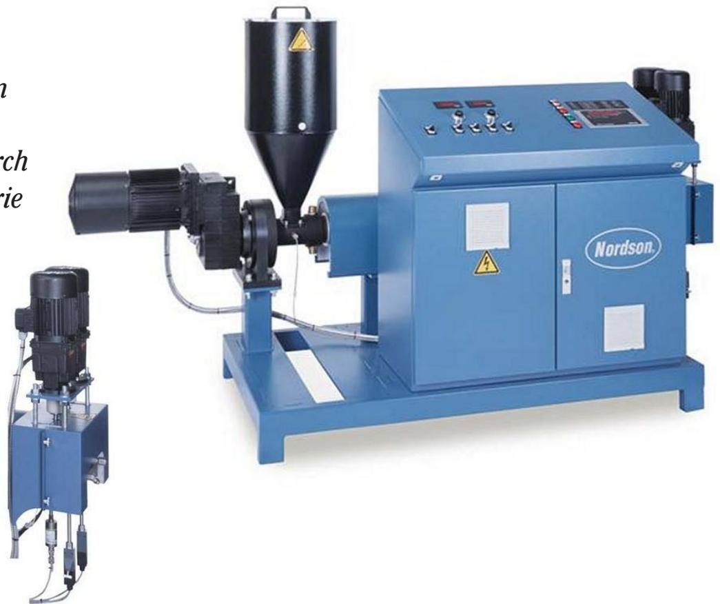
Die Nordson EEX Extruder Serie ermöglicht das homogene und schonende Aufschmelzen von Klebstoffen in Granulatform. Hierbei wird immer nur soviel Klebstoff aufgeschmolzen wie für die Applikation benötigt wird. Dies ermöglicht eine wartungsfreie Produktion und die Oxidation von Klebstoffen ist nahezu unmöglich. Des Weiteren ist der Einsatz von verschiedenen Klebstoffen ohne Reinigung des Extruders möglich.
